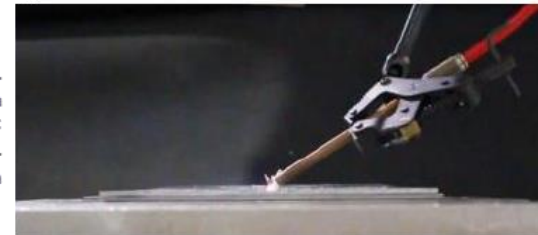
Laserstrahlschweißen von AL-Druckguss: HF-Strahloszillation
